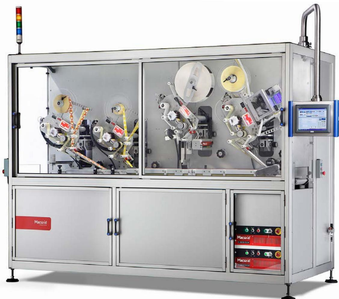
En el caso de la etiqueta inferior, un equipo Láser CO2 permite el marcaje de los ingredientes, valores nutricionales y método de preparación, a una cadencia de 0,4 segundos por etiqueta, sobre sustrato de papel térmico.
